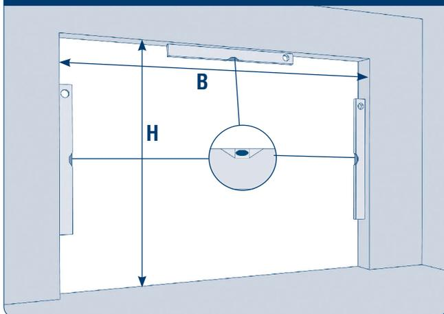
**H** — высота проема (расстояние от пола до верха проема)  $\pm 3$  мм.
